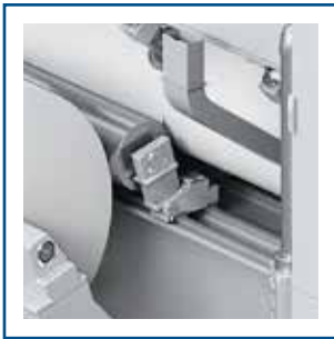
2 Idle lay-on rollers
